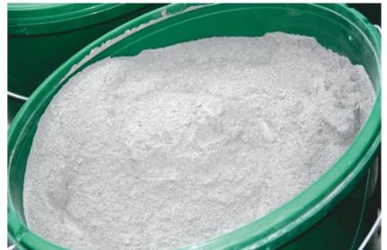
Rudomal je rychle tuhnoucí kamnářské, dobře se roztírající lepidlo (tzv. Haftmörtel) určená pro sezdívání a lepení žárovzdorných materiálů s teplotní odolností do 1100°C, natahování perlínky a srovnávání povrchu akumulačních staveb krbů a kamen.
