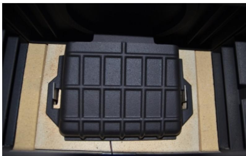
tento díl slouží v kamnech ke směru toku spalin. Jeho kvalita a opotřebení má velký vliv na dosažené nízké emise a kvalitu provozu, tedy využití paliva - účinnost.
